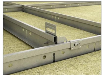
Per far sì che la staffa abbia funzione di "ponte", avvitare la Staffa a Muro e di connessione per profili a T sia ai profili portanti che ai profili intermedi. La creazione di questo "ponte" tra i profili permette di trasferire il peso degli impianti direttamente alla struttura di sospensione del controsoffitto. Questo assicura che non ci siano carichi sui pannelli, eliminando i rischi di flessione.
