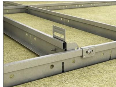
Per far sì che la staffa abbia funzione di "ponte", avvitare la staffa stessa per profili a T sia ai profili portanti che alle traversine, in questo modo il peso degli impianti sarà trasferito direttamente alla struttura. Questo assicura che non ci siano carichi sui pannelli, eliminando i rischi di flessione.
