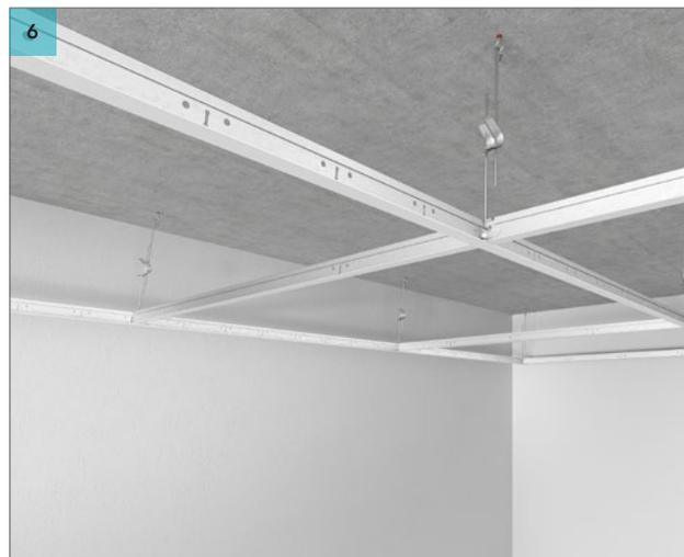
Inserire i profili intermedi T24 Click 1200 mm nel profilo portante a passo 1200 mm.
