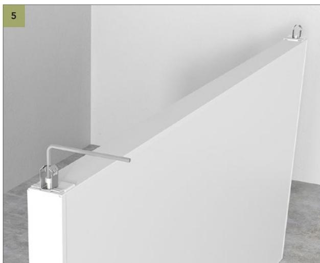
Connettere due Clip di Fissaggio in corrispondenza delle clip multifunzione integrate nella cornice del baffle usando una brugola e un bullone M6. Assicurarsi che le Clip di Fissaggio siano posizionate parallele alla lunghezza del baffle come da immagine superiore.
