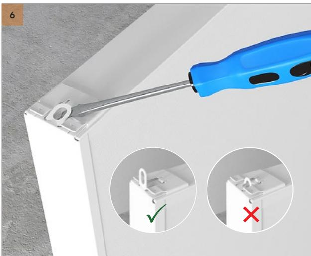
Sollevare l'occhiello delle clips multifunzione integrate nella parte superiore della cornice del Baffle.
