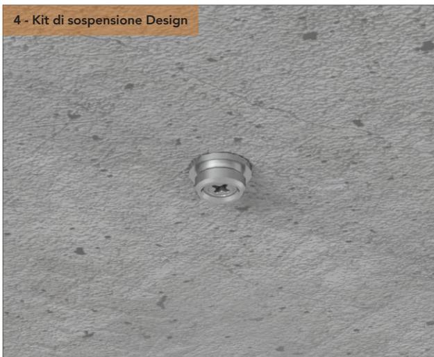
Fissare a soffitto la ghiera superiore del Kit di sospensione Design ( elemento con filettatura esterna M13). Usare la vite di fissaggio idonea al tipo di materiale di base del soffitto e avente dimensione sufficientemente piccola da essere inserita all'interno del cilindretto di copertura del Kit di sospensione Design ( diametro massimo della testa della vite 12 mm).
