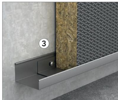
Il profilo a J da 40 mm (25/40/13 mm) e la staffa di supporto vengono utilizzati per sostenere la parte inferiore dei pannelli murali quando questi sono montati a più altezze o distanti dal pavimento. Quando si utilizza il profilo a J spesso 1 mm, le staffe di supporto non sono necessarie.
