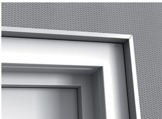
3.9 Un profilo a J che termina attorno a una porta o a una finestra dev'essere montato alla parete sempre dalla parte del suo lato largo 25 mm (fissaggio a 30 mm da ciascuna estremità e in seguito ogni 300 mm). Per minimizzare lo sfrido dei pannelli, misurare e tagliare attentamente garantendo al tempo stesso un'adeguata sovrapposizione dei profili a J.
