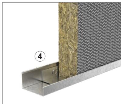
Il profilo a J da 40 mm (25/40/13 mm) e la staffa di supporto vengono utilizzati per sostenere la parte inferiore dei pannelli murali quando questi sono distanti dal pavimento o montati all'interno di installazioni ad altezza multipla.
