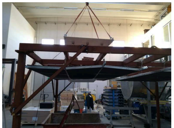
Fotografia della porzione di controsoffitto "A" dopo l'impatto n. 10
