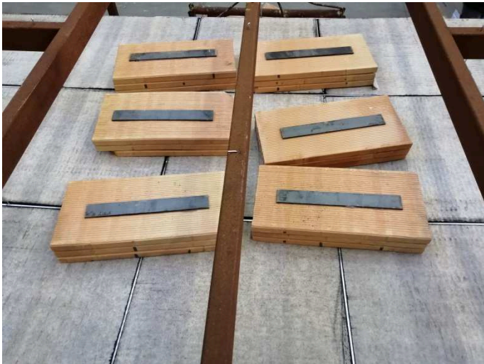
Fotografie della superficie d'estradosso della porzione di controsoffitto "B" dopo la prova
