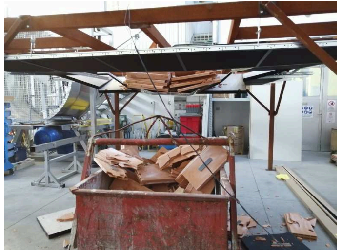
Fotografia della superficie d'intradosso della porzione di controsoffitto "A" dopo l'impatto n. 11
